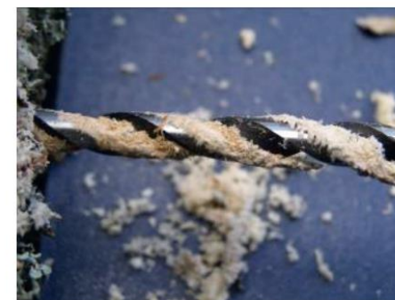
Древесина, пораженная гнилью (бурая стружка)
