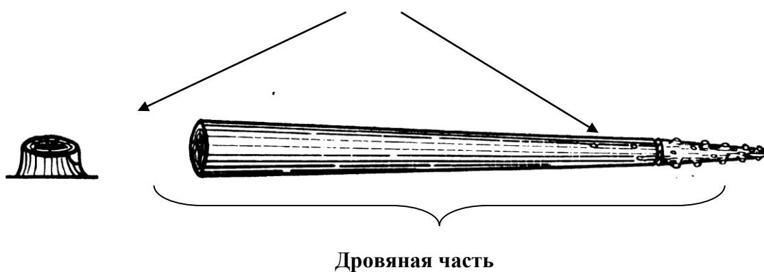
Рисунок Ж.2 - Схема отбора проб дровяной древесины от деревьев дровяной категории технической годности
